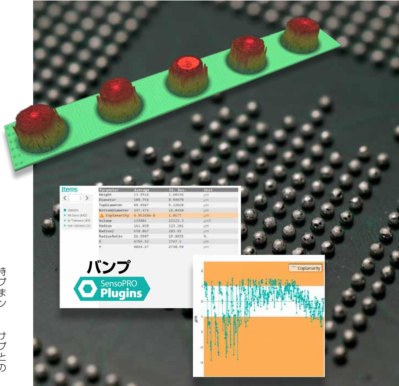
2つ目の条件は、BGA(Ball Grid Array)コネクタの特性評価です。このタイプのコネクタでは、一部のバンブは電氣的に試験されますが、他のバンブはテストされません。プローブ試験をされると、バンブはプローブピンの圧力によって高さが減少します。
