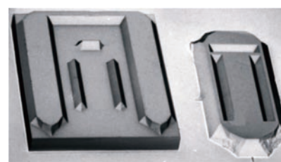
アライメントチップ (ALIGN) (左)とアライメントチップ対応プローブのホルダー部の SEM イメージ
