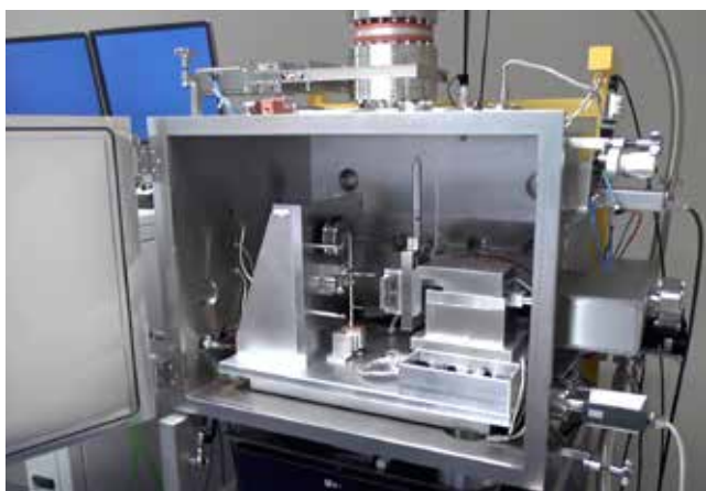
図1: 真空チャンバ内に設置した NanoTest Xtreme
